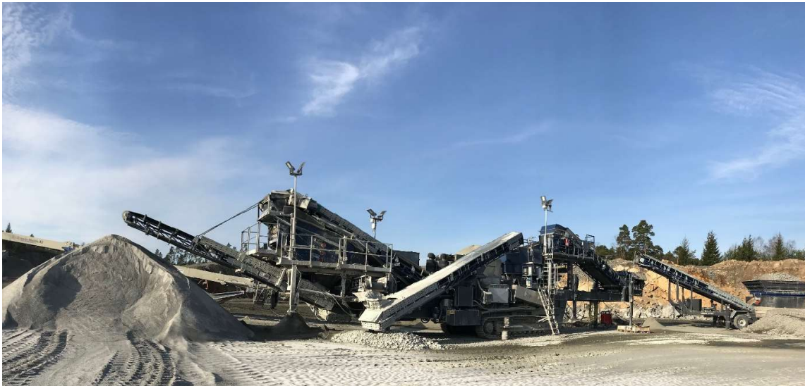
Figur 5. Mobil kross kopplat till mobil sikt i Bugärde
