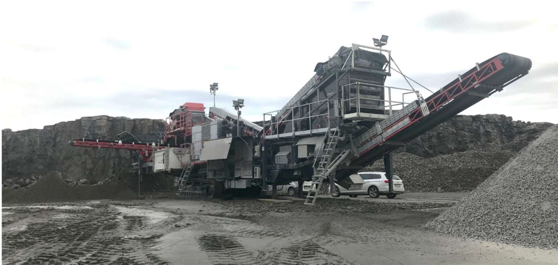
Figur 9. Mobila krossen kopplat till mobil sikt i Arendal.
